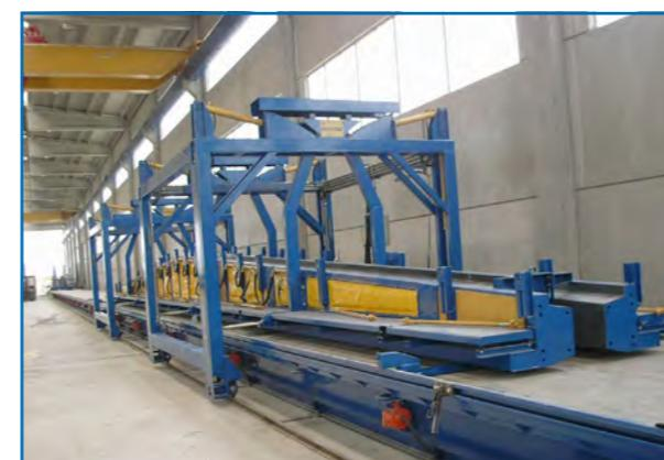
**Molde para prefabricado**
